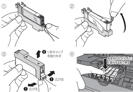
④インクカートリッジのラベル色とプリンタの挿入箇所の色を合わせ、「カチッ」と音がするまで押してセットしてください。
