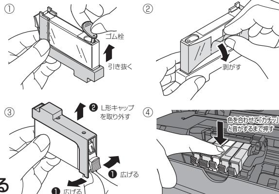
④インクカートリッジのラベル色とプリンタの挿入箇所の色を合わせ、レバーが「カチッ」と音がするまで押してセットしてください。
